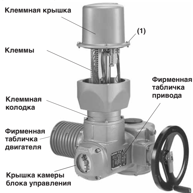
рис. G2: Штекерное клеммное подключение
