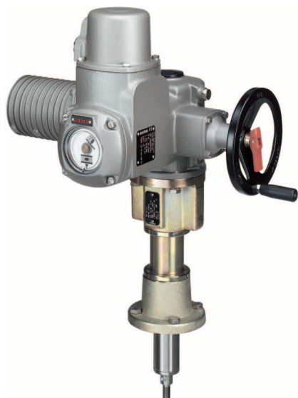
Прямоходный механизм LE с электроприводами SA усилие на штоке от 4 кН до 217 кН величина хода до 500 мм скорость перемещения от 20 до 360 мм/мин.
